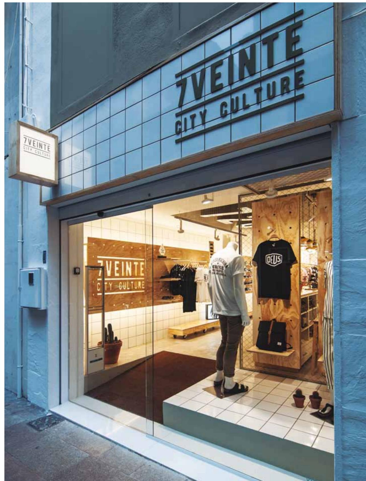
El diseño del sistema expositivo de contrachapado de pino perforado, que recorre longitudinalmente las paredes salvando los pilares, se inspira en el clásico panel de herramientas. Se convierte en un ele-
